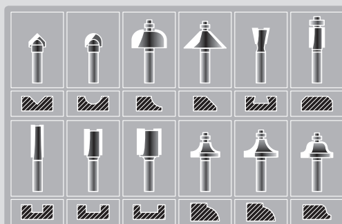
Abb. 1, Profilform an Abhängigkeit vom eingesetzten Profilfräser
